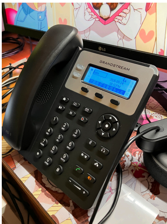
図 2: WireGuard 経由で通話が可能となった IP 電話機
